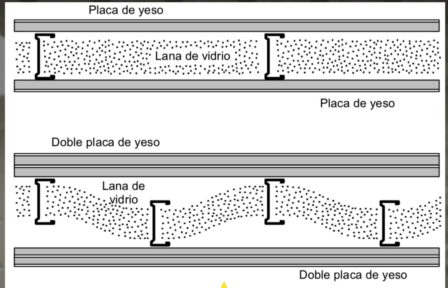
**Montaje de placas de roca de yeso con estructura formada por perfiles de chapa. Estructura alternada sin conexión rígida.**
